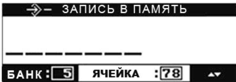
Рис.45. Вид экрана в режиме записи в память
