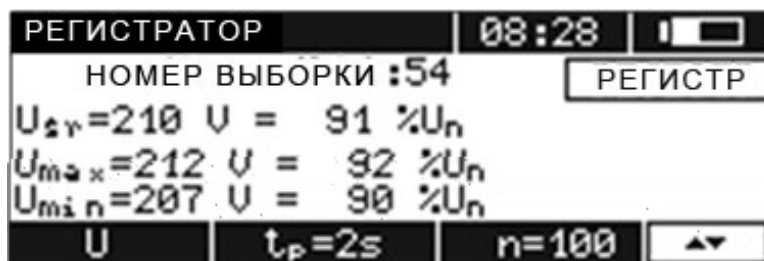
Рис.41. Вид статистических значений в процессе регистрации напряжения сети а)
