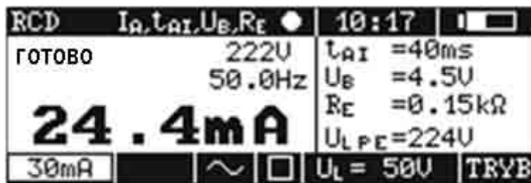
Рис.18. Вид экрана при измерении тока отключения УЗО
