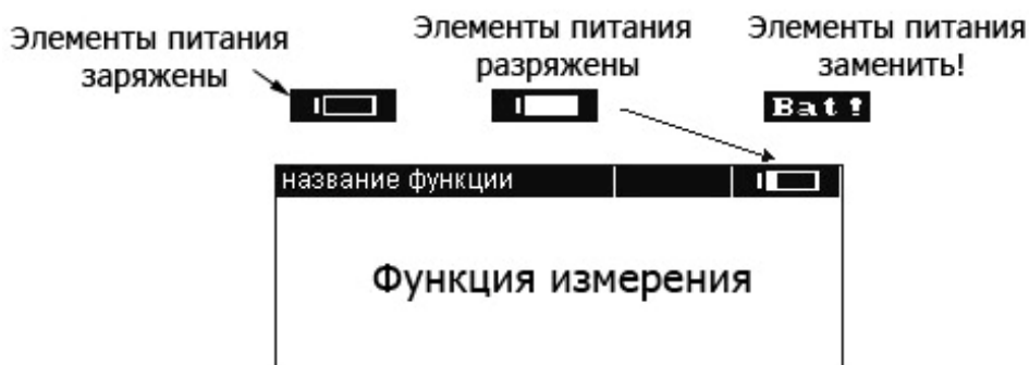
Рис. 51. Мониторинг состояния зарядки элементов питания или аккумуляторов
