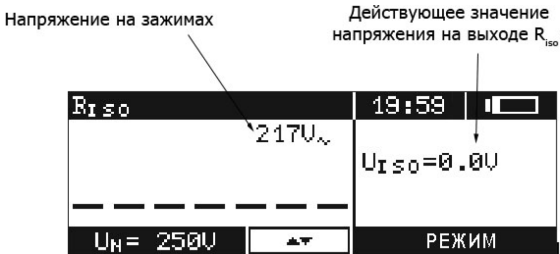
Рис.26. Организация экрана при измерении сопротивления изоляции
