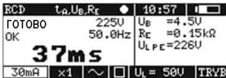
Рис.20. Вид экрана при измерении времени отключения УЗО
