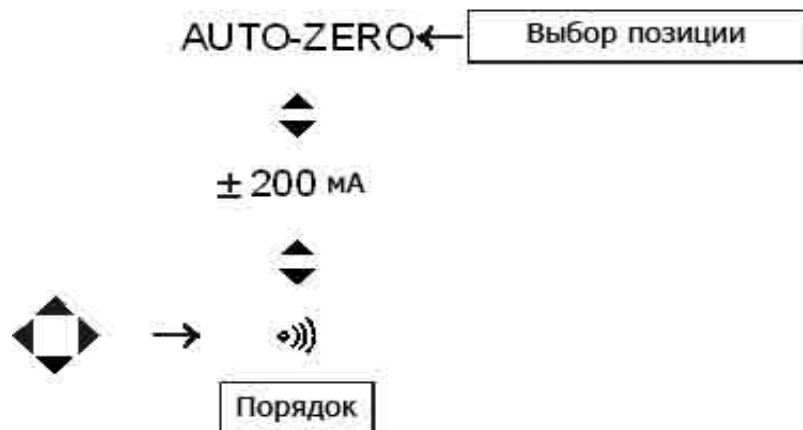
Рис.37. Установка режима компенсации сопротивления измерительных проводов
