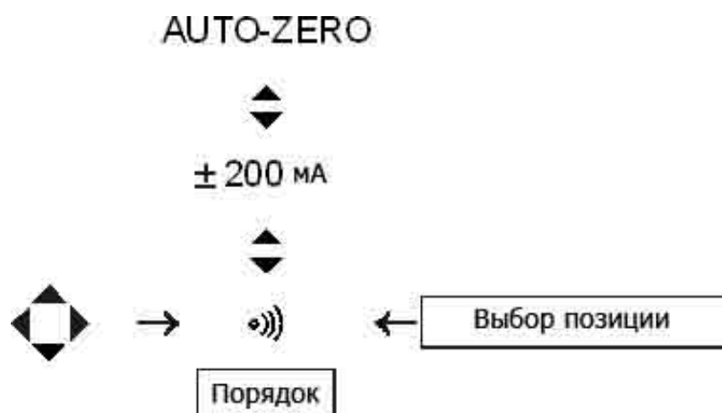
Рис.34. Установка режима измерения сопротивления низким напряжением
