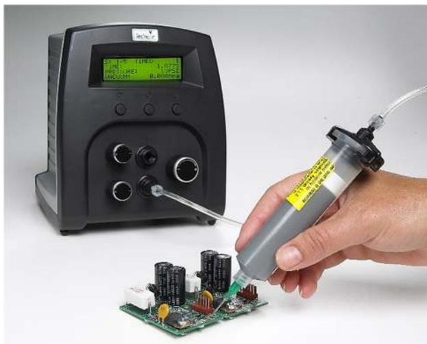
Серия дозаторов TS350 точно и аккуратно дозирует материалы низкой, средней и высокой вязкости. Как и все цифровые дозаторы Techcon, TS350 имеет понятный и простой интерфейс, не требует длительной настройки. Устройство имеет большой ЖК дисплей, отображающий режим работы цифрового таймера и рабочих давлений.
