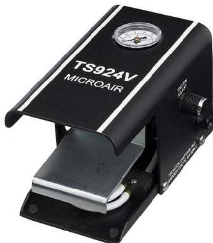
Дозатор TS924 сочетает в себе высокую производительность и небольшую цену. Дозатор устанавливается на пол под ногу монтажника. Устройство имеет регулятор давления и уникальный клапан переключения давления. Нажимом и продолжительностью нажатия на педаль монтажник может контролировать давление и время дозы соответственно. Модель TS924 - это идеальный дозатор для большинства операций по нанесению клеев, герметиков, специальных покрытий и компаундов. Так же дозатор не требует электропитания.
