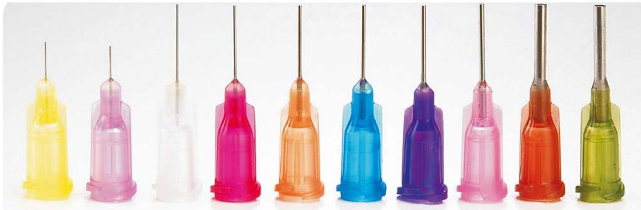
Высокоточные иглы-насадки серии TE изготовлены из нержавеющей стали с основанием из двух слоев полипропилена для надежного крепления иглы. Игла имеет внутреннюю обработку электрополировкой для беспрепятственного равномерного потока материала. Иглы не содержат хлоридов и силиконов. Максимальной рабочее давление 6.9Бар. Иглы продаются упаковками по 50 штук.
