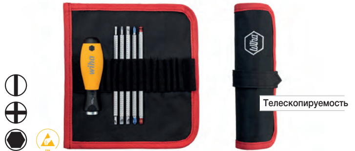
284ESD T6 01 SYSTEM 6, набор комбинированных жал ESD, 6 предметов. Шлиц / Phillips / шестигранник / шестигранник со сферической головкой.
