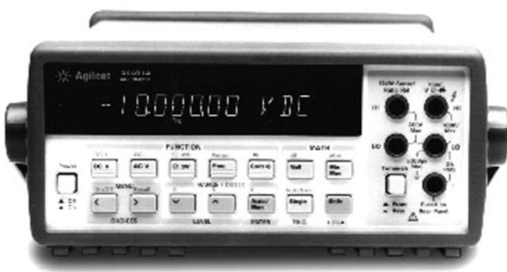
**Погрешность мультиметра ±(% от показания + % от предела измерения)**
