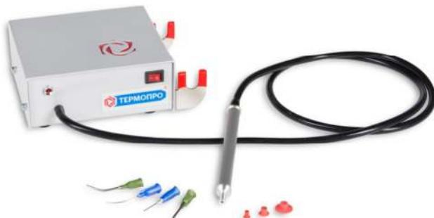
Вакуумный пинцет ВМ-045 предназначен для безопасной и удобной работы с электронными компонентами. Вакуумный пинцет в зависимости от используемой присоски обеспечивает поднятие гладких не пористых объектов весом до 200 г (с присоской Ф13мм). Ручка пинцета, термостойкие присоски, воздушный шланг изготовлены из антистатических материалов для уменьшения риска электростатического повреждения электронных компонентов.
