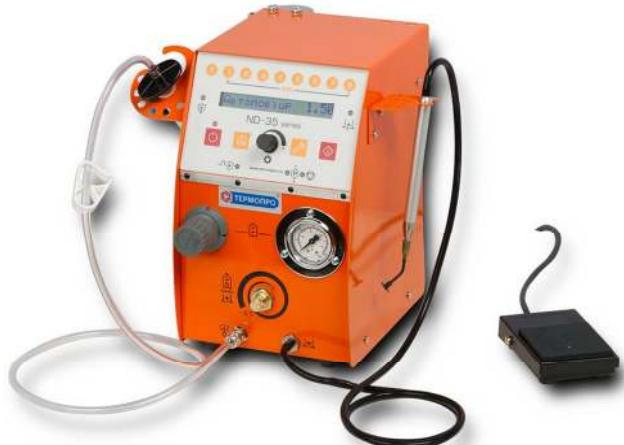
Программируемый дозатор серии ND-35 - промышленный прибор, предназначенный для дозирования паяльных паст, флюсов, клеев, герметиков, смазок и других жидких и пастообразных материалов с помощью пневмоимпульсов. Серия дозаторов ND-35 разработана на базе унифицированной платформы. В серию входит шесть основных вариантов дозаторов, отличающихся функциями и назначением.
