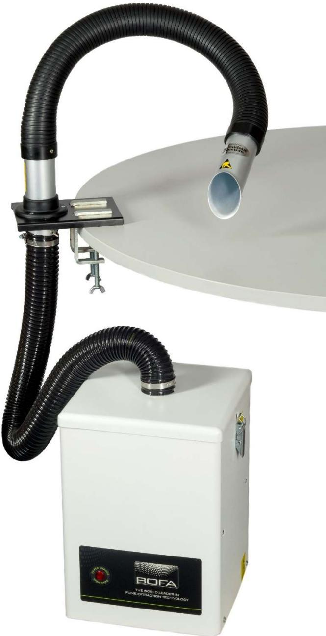
Данная система комплектуется гибкими эргономичными дымоприемниками ALSIDENT диаметром 50мм с металлическим растробом. Такой дымопремик легк сгибаются и «запоминает» заданную форму. Его можно расположить сбоку от места пайки и максимально близко к источнику дыма, что обеспечивает высокую скорость всасывания, при этом дымоприемник не затеняет рабочую зону и совершенно не мешает монтажнику.
