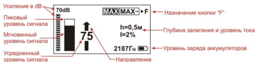
Расположите antennu в положение по максимуму, расположение кабеля определяется по максимальному уровню
