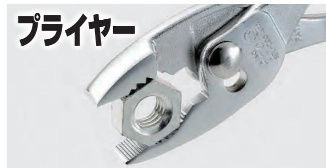
プライヤーはジョイント部が二段階にスライドする構造で、掴む範囲が広く大きなボルトやナットでも掴む事が可能です。掴む時は、板状の薄い物は先端で、大きくて丸い物は中央の凹部で挟むとしっかりと掴めます。また、表面に錆に強くするためメッキ処理を行い、ジョイント部には針金などが切れる切断刃が付いています。自動車・バイク・自転車などのメンテナンスや家庭用に多方面で活躍します。
