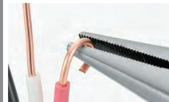
電源スイッチや電気器具・工作機械の接続時に電線をまるめたり、曲げたり、のぼしたりする事ができます。
