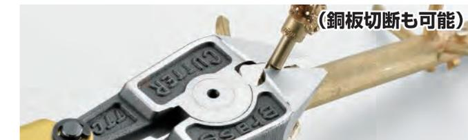
ジュエリー制作に使用する真鍮などの柔らかい金属を軽い力で切断する事ができます。また、ロストワックス铸造のキャストツリーからの切り放しにも最適です。
