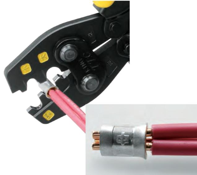
電気工事士技能試験では、リングスリーブの圧着においてリングスリーブに **JIS C 9711** に適合する圧着マークが刻印されることが求められます。
