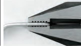
金属板をくわえ部全体でつかみ、ハンドルの下側を強く握って曲げると板が外れずに作業ができます。
