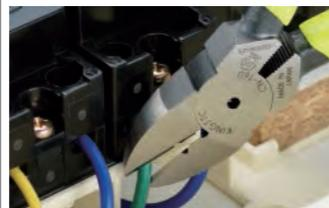
先端から切断刃がついているので、配電盤などせまい所の電線の切断作業が楽にできます。
