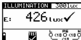
Рисунок 5.56: Пример результатов измерения освещённости
