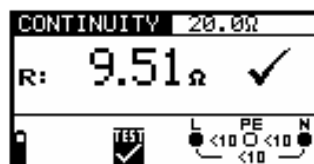
Рисунок 5.18: Пример результатов измерения непрерывности
