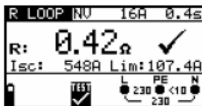
Рисунок 5.36: Пример результатов измерения сопротивления петли
