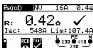
Рисунок 5.38: Пример результатов измерения сопротивления петли с использованием функции trip-lock (блокировка размыкания)
