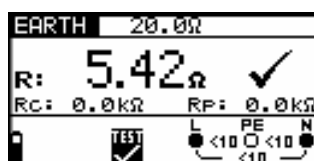
Рисунок 5.50: Пример результатов измерения сопротивления грунта
