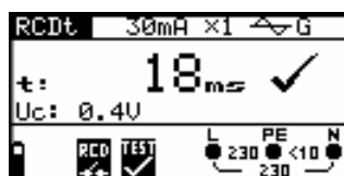
Рисунок 5.24: Пример результатов измерения времени срабатывания
