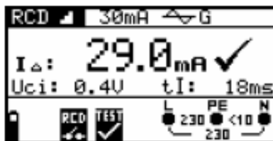
Рисунок 5.26: Пример результатов измерения Тока размыкания
