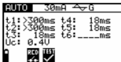
Рисунок 5.32: Результаты 5 шага автоиспытания RCD
