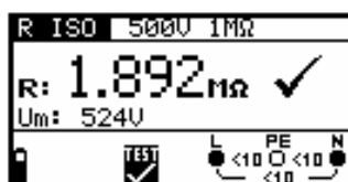
Рисунок 5.3: Пример результатов измерения сопротивления изоляции Отображаемые результаты:
