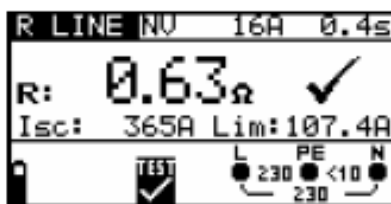
Рисунок 5.41: Пример результатов измерения сопротивления линии
