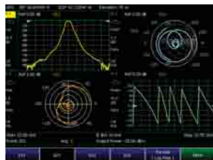
Измерение и одновременный просмотр всех четырех S-параметров за одно подключение
