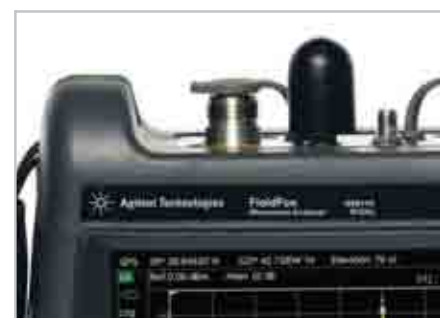
Использование встроенного GPS-приемника для получения данных геолокации
