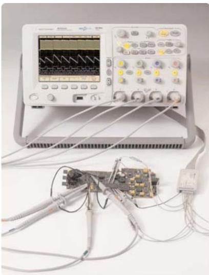
**Рисунок 2 - Осциллограф смешанных сигналов (MSO) с 4+16 каналами позволяет одновременно просматривать до 4 аналоговых и 16 логических сигналов**
