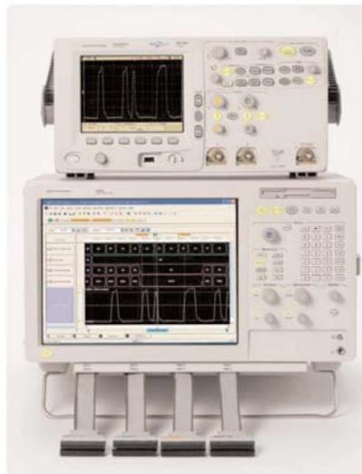
**Рисунок 9 - Выполнение коррелированных по времени измерений между логическим анализатором компании Agilent и осциллографом серии 6000**
