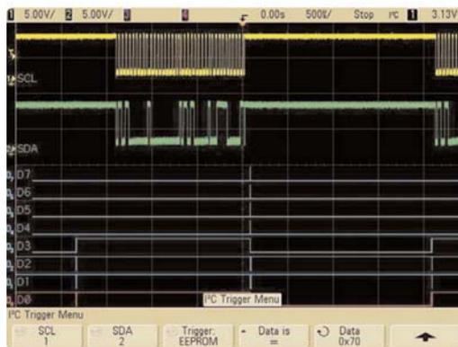
Рисунок 11 - Запуск по кодовым словам адреса и/или данных внутри кадра I<sup>2</sup>C
