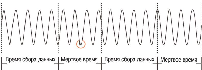
**Рисунок 4 - Медленная скорость обновления осциллограмм предполагает продолжительное мертвое время, когда аномалии могут быть пропущены. При скорости обновления осциллограмм, равной 100000 осциллограмм/с, мертвое время сведено к минимуму**
